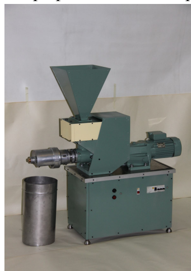
Рис. Загальний вигляд розробленого конусного злущувача-подрібнювача насіння олійних культур.
