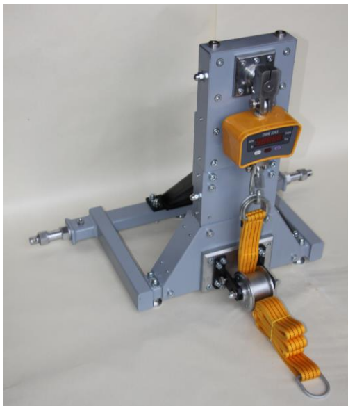
Рис. Загальний вигляд пристрою для визначення показників тягово-зчіпних властивостей мобільних засобів
