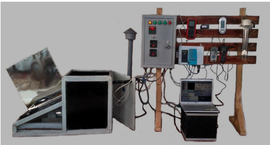
Рис. Загальний вигляд лабораторної установки для дослідження параметрів геліосушарки з тепловим акумулятором та плоским дзеркальним концентратором.
