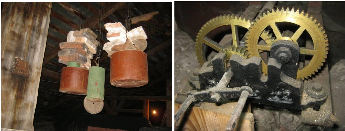
Рис. 2. Гирі і вексельний механізм
