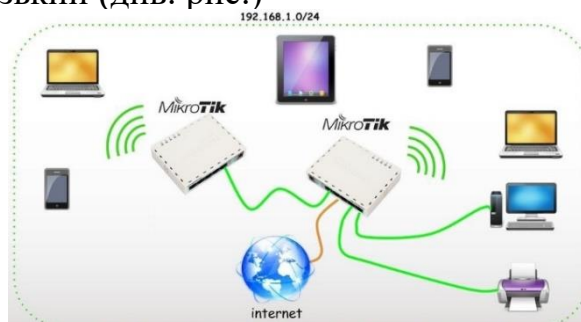
Рис. Реалізація безшовного Wi-Fi без контролера на базі маршрутизаторів Mikrotik
