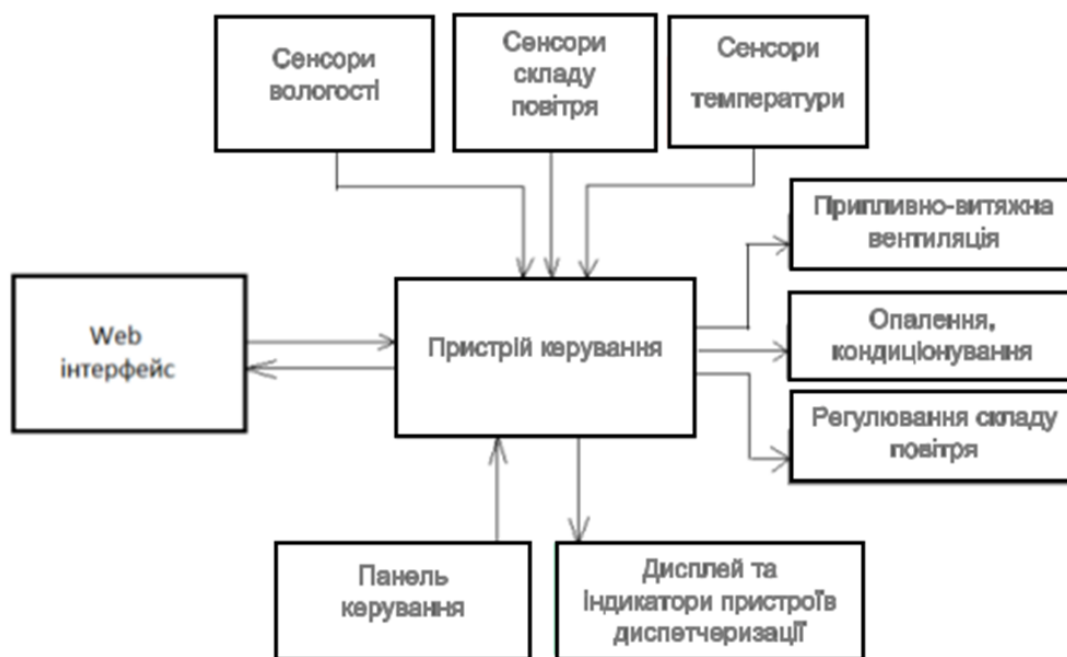
Рис. Структурна схема автоматизованої системи керування мікрокліматом виробничого приміщення, яка складається з 10 блоків
