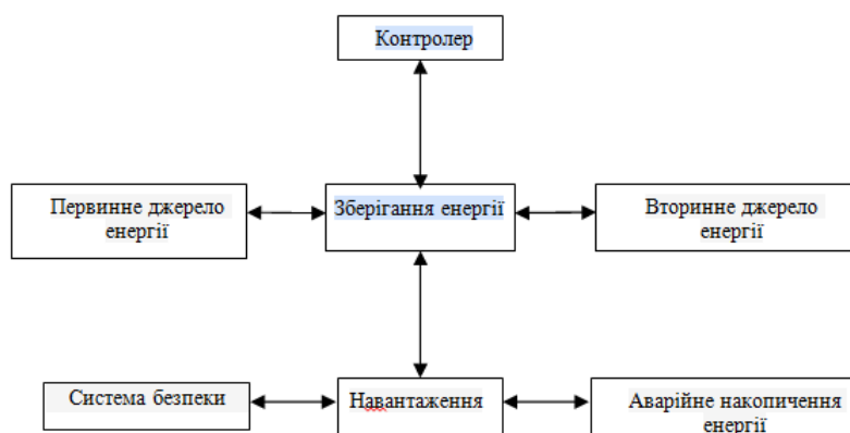
Рис. 1. Блок-схема автономної системи живлення (АЕС)
