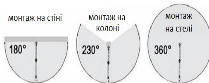
Рис. 2. Кути повороту підвісних витяжок
