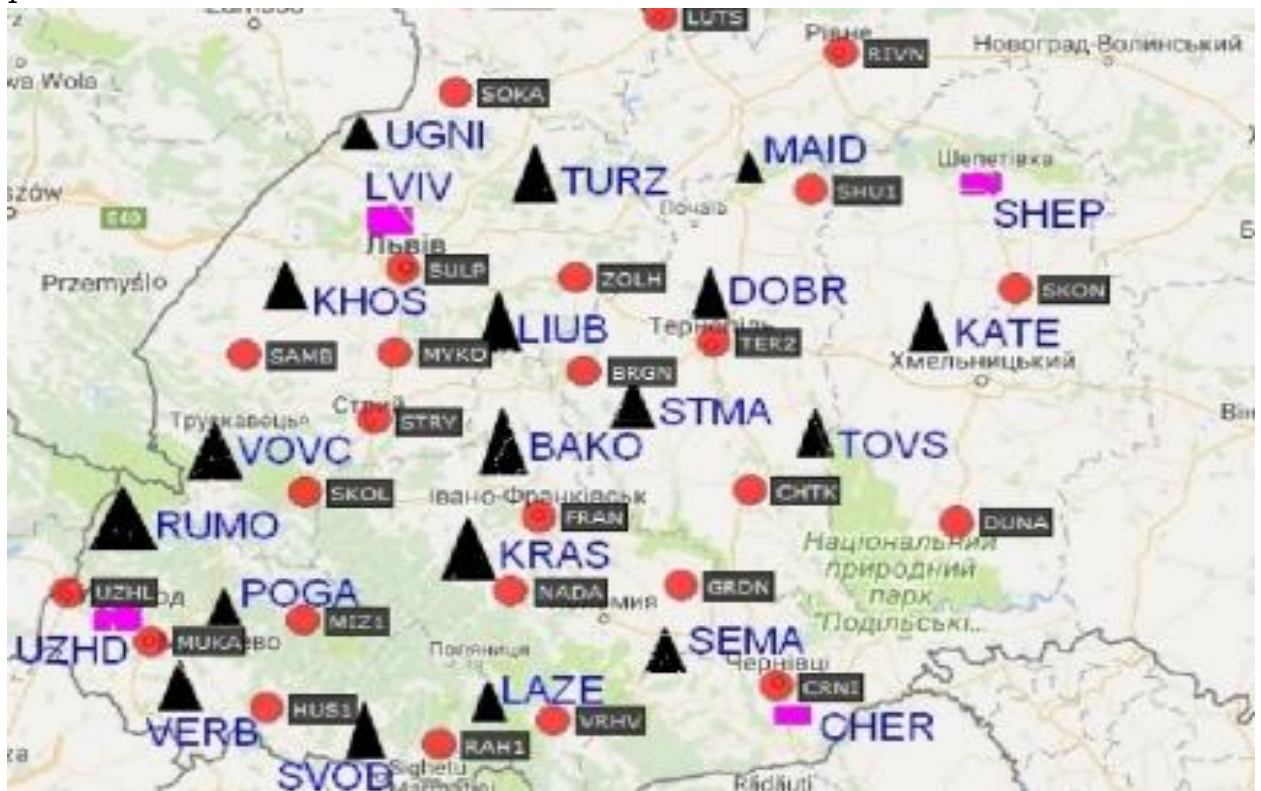
Рис. 1. Схема контрольної геодезичної мережі, де червоним кольором виділено референційні GNSS станції, чорним – пункти Державної геодезичної мережі.
