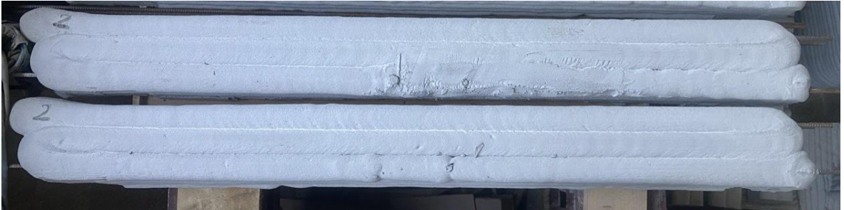
Рис. 1. Балки виготовлені методом 3D друку
