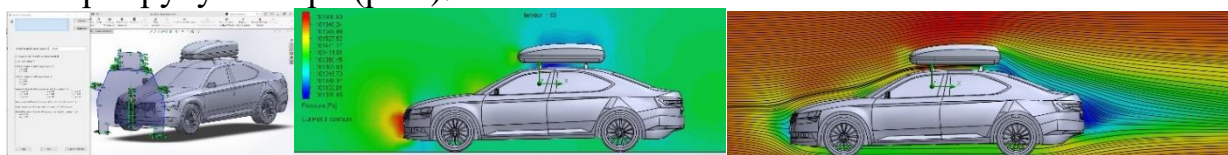
Рис. 1. Визначення лобової площі автомобіля
