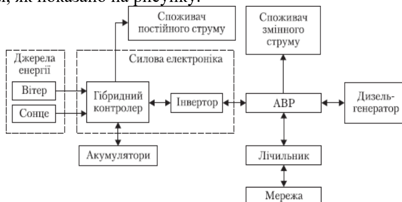
Рис. Схема електрозабезпечення на базі гібридної установки сонце – вітер
