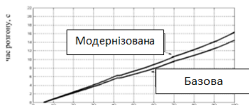
Рис. 2. Порівняльні графіки розгону електромобіля.
