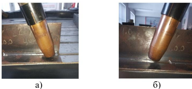
Рис. 1. Положення пальника під час зварювання а – кутом вперед; б – кутом назад
