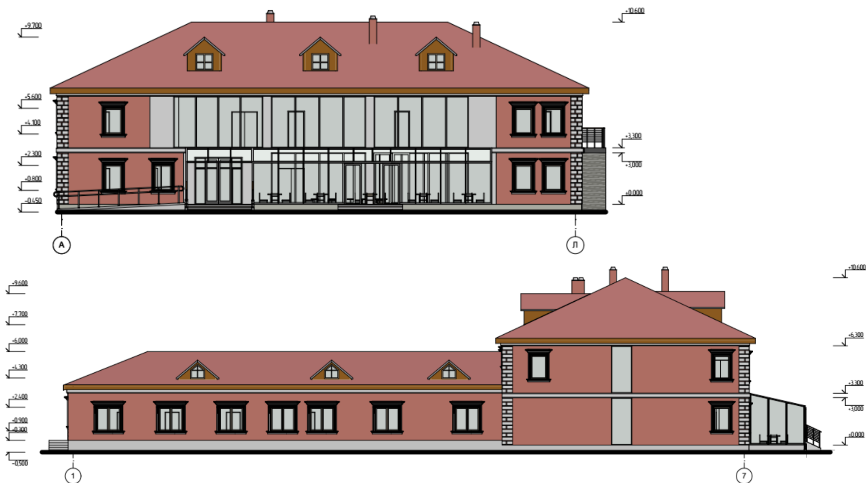
Рис.5. Фасад А-Л, фасад 1-7.
