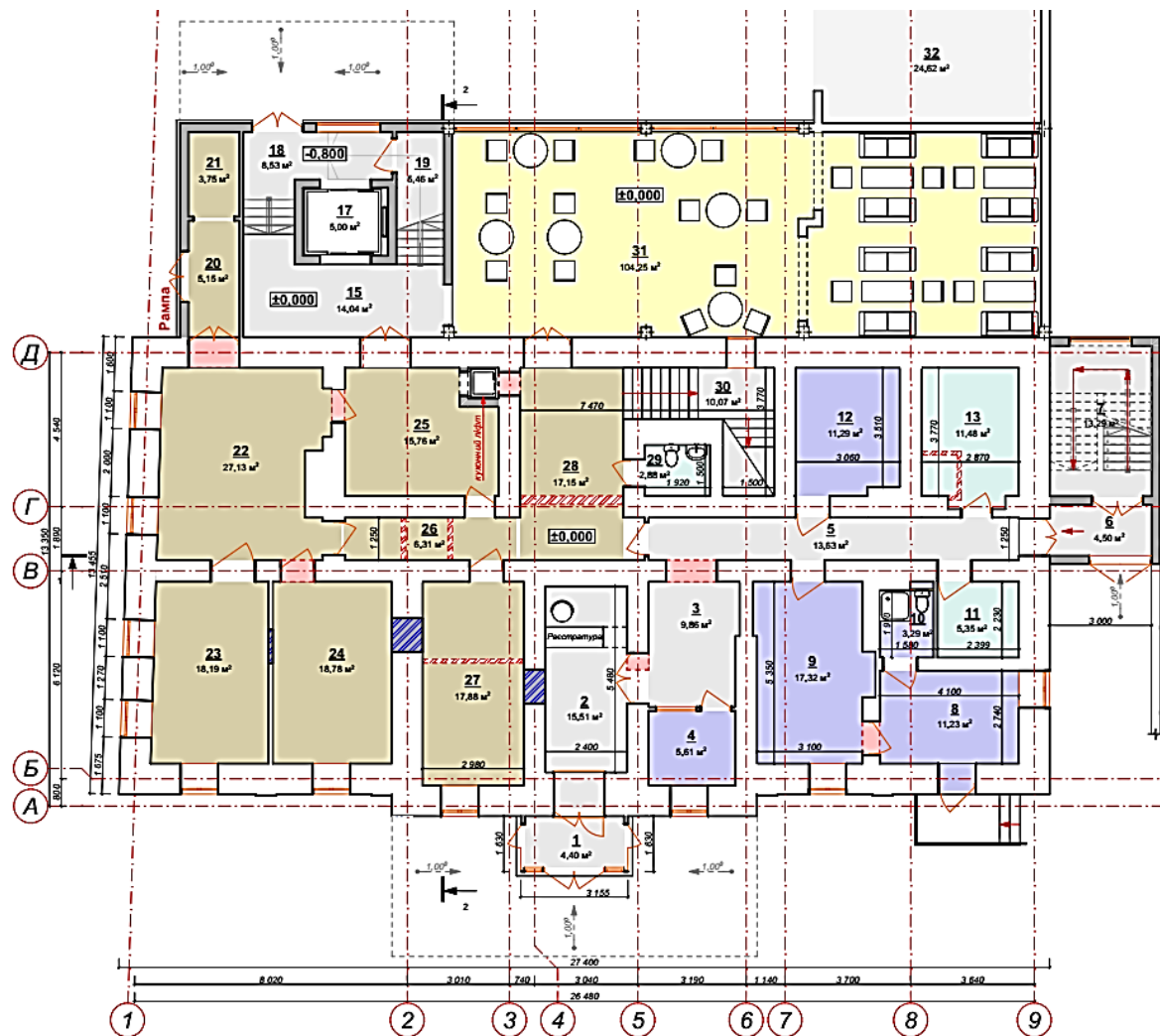
Рис.4. План першого поверху будівлі готелю з кафе-рестораном.
