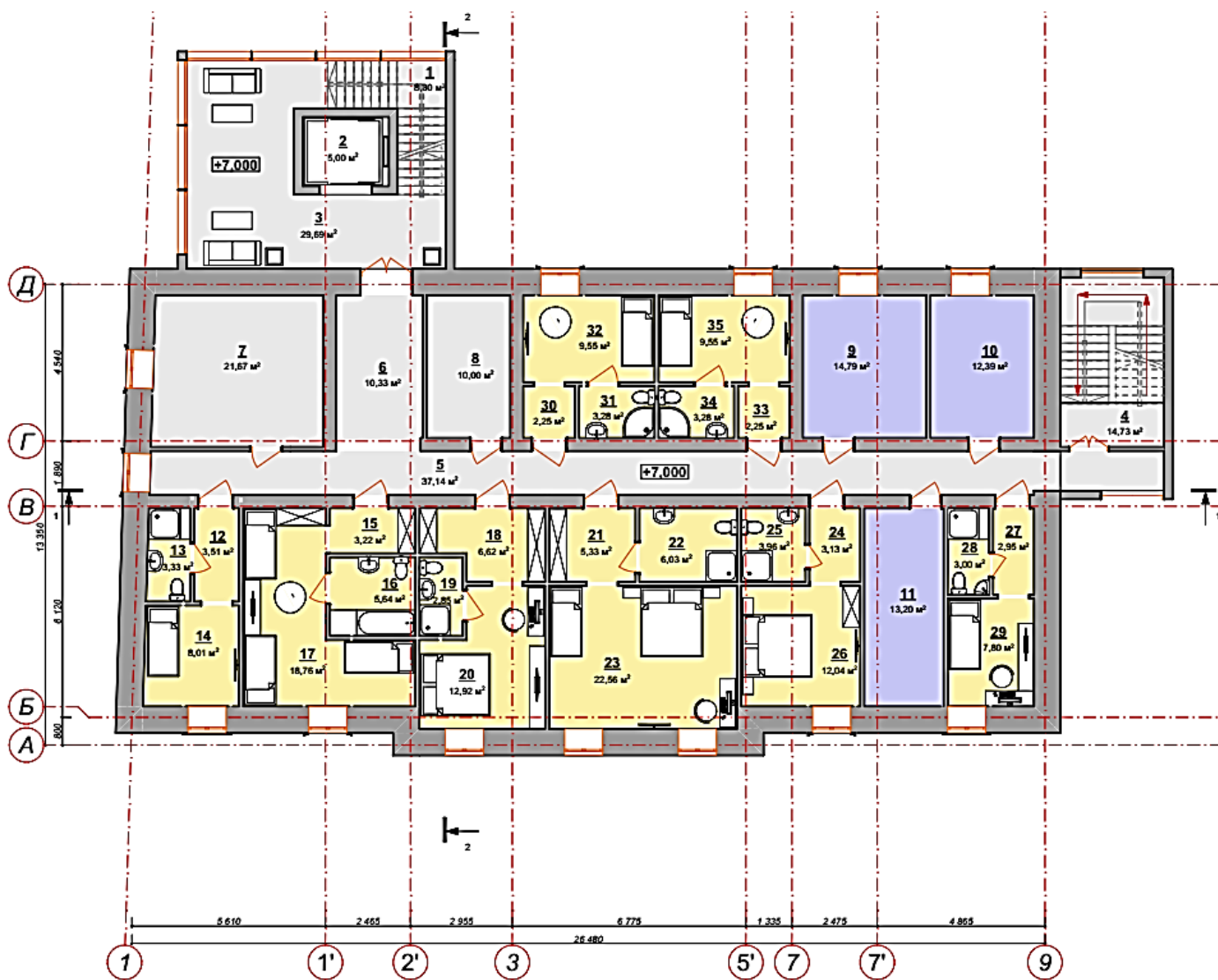
Рис.6. План мансардного поверху будівлі готелю з кафе-рестораном.
