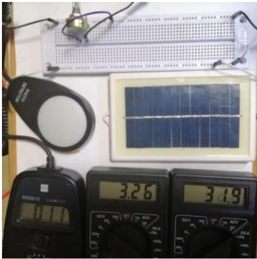
Рисунок 1 – Експериментальна установка для визначення вольт-амперної та люкс-вольтової характеристики фотоелементу
