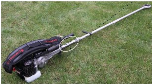
Рис. Ручний віброударний струшувач плодів.
