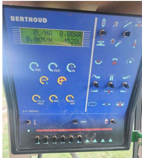
Рисунок 1.11.11. Пульт DP Tronic керування автоматичною системою виливу.
