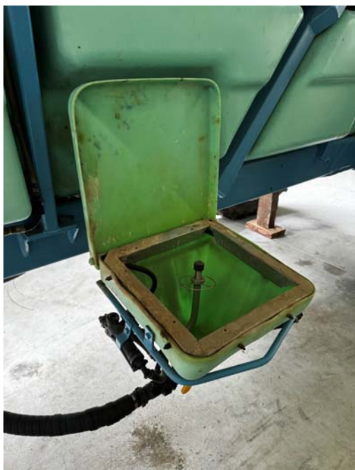
Рисунок 1.11.8. Заповнення та змішування засобів захисту рослин.
