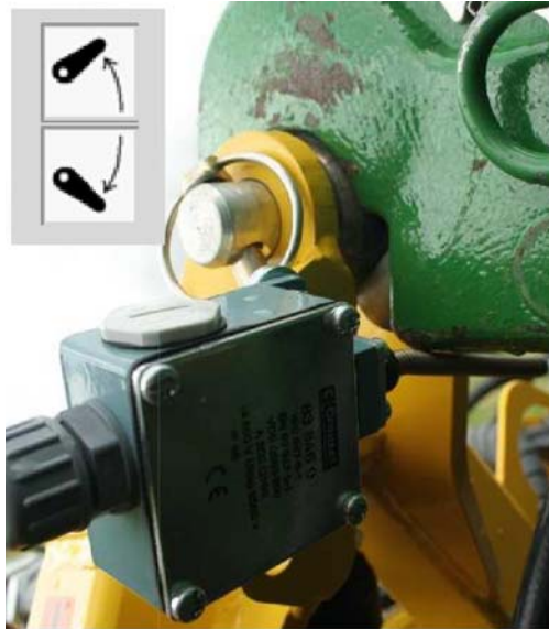
Рисунок 1.10.8. Налаштування датчику положення навіски.
