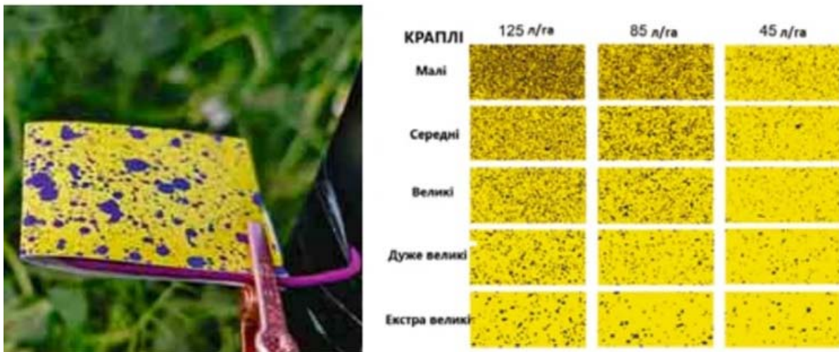
Рисунок 1.11.12. Тест якості нанесення робочого розчину на рослини, за допомогою лакмусового паперу.
