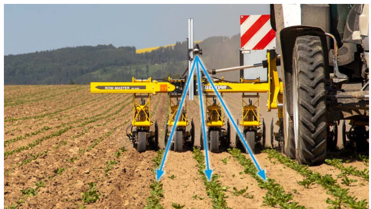
Рисунок 1.10.7. Розташування камери на міжряддя 45 см.
