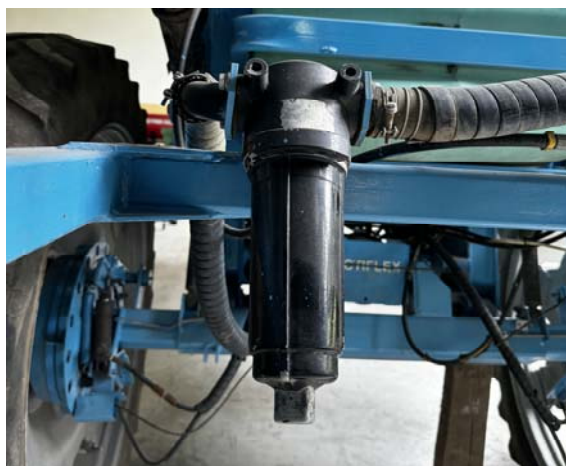
Рисунок 1.11.4. Лінійний фільтруючий елемент на лінії оприскування.
