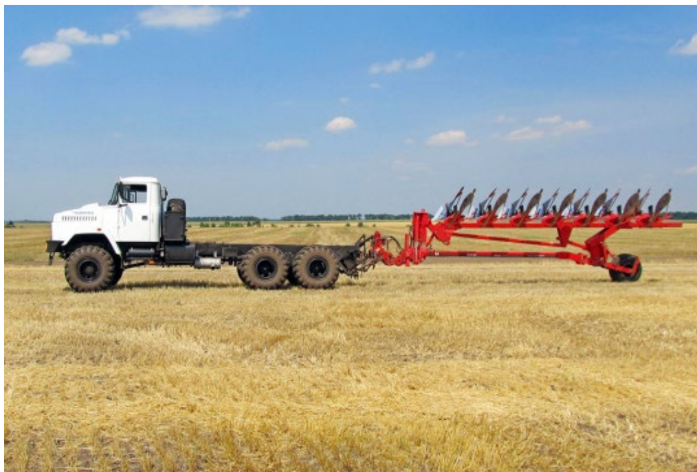
Рисунок 1.26 – Загальний вигляд МЕЗ-330 з багатокорпусним плугом [58]
