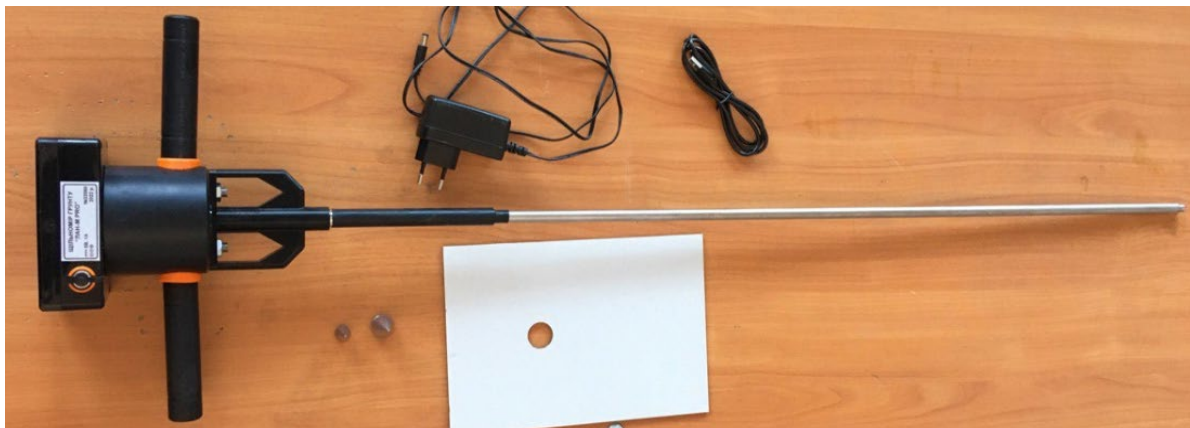
Рисунок 4.2 – Загальний вигляд твердоміра ґрунту ЛАН-М PRO [173].
