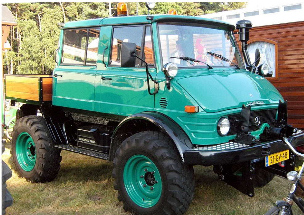
Рисунок 1.4 – Загальний вигляд Unimog 406 (подвійна цільнометалева кабіна) [5]
