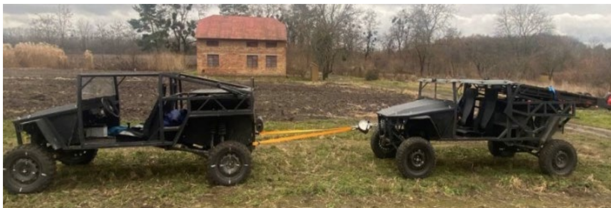
Рисунок 4.8 – Експериментальне визначення класу тяги військового баггі ТУР КВ-02 «Мамай» (загальний вигляд експерименту)
