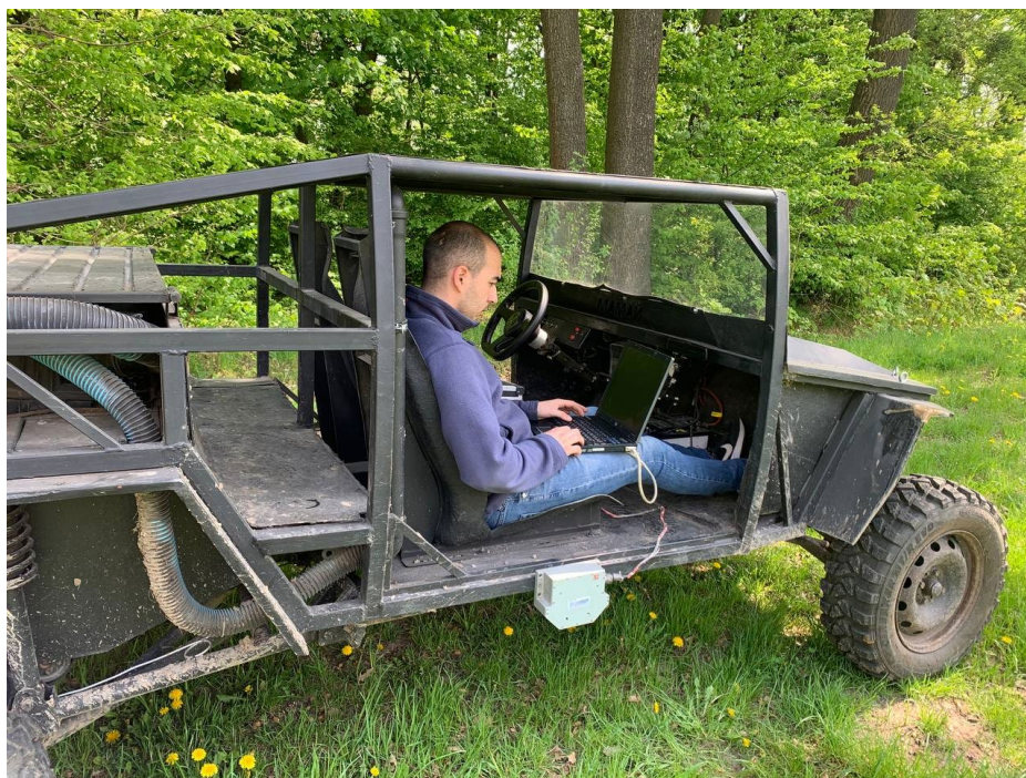
Рисунок 4.5 – Розміщення вимірювального комплексу РПВР на об'єкті випробувань – баггі ТУР KB-02 «Мамай»
