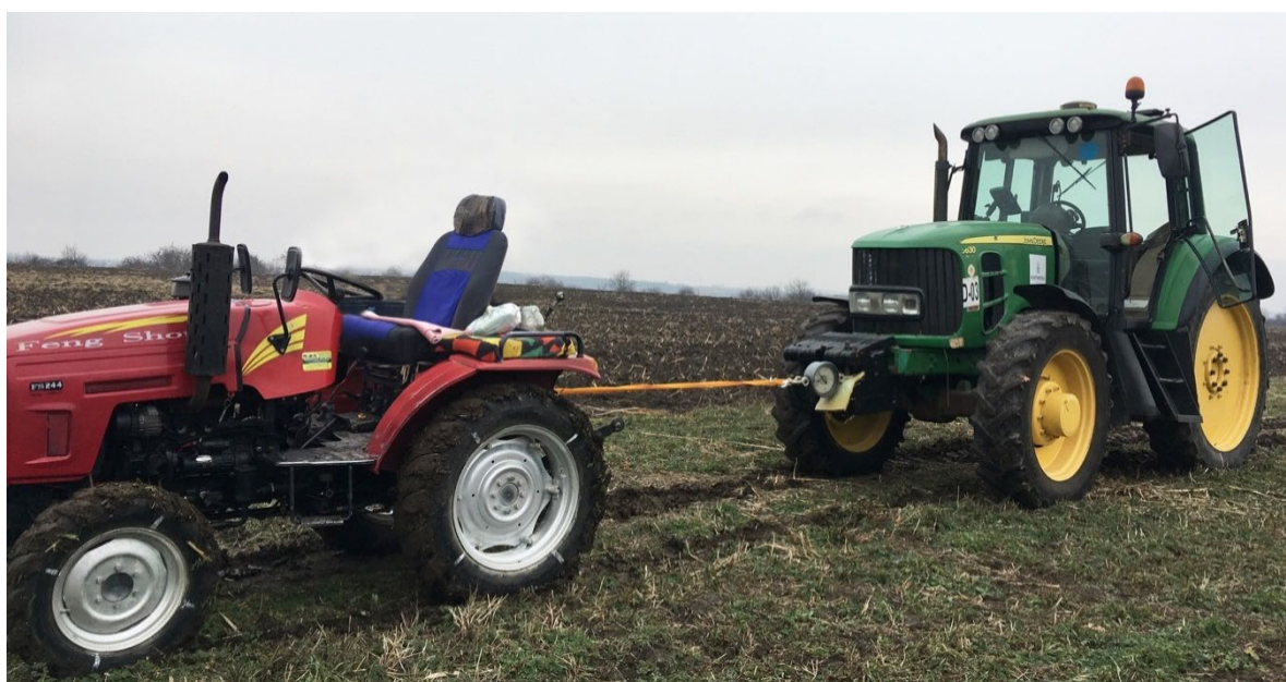
Рисунок 4.7 — Експериментальне визначення класу тяги трактора Mahindra Feng Shou FS244 (загальний вигляд експерименту)
